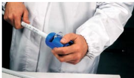
Fig. 13 - Stripping av PP - mantel
