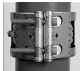
4. Dra kragens bolter til slik at boltfestene på begge sider av svepet møtes. Kragens tenner griper nå rundt begge rørender og sikrer skjøten mot trykk opp til 10 bar.
